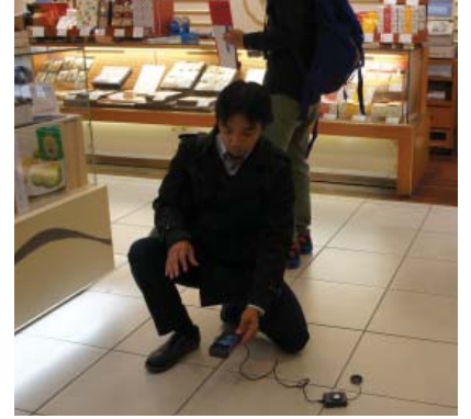
ショーケース前の床面照度を測定
