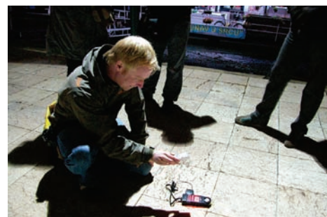
煌々と輝く街路灯の下で照度測定中。周囲は暗闇なのに、街路灯の直下は100ルクスもあるのは明るすぎないか？！
